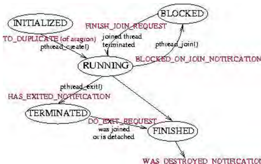
FIG. 10.8 – Diagramme d'état d'un thread, et messages échangés lors des transitions
