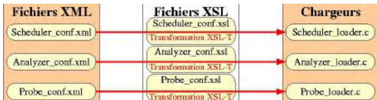
FIG. 10.1 – Détails de la génération du code des différents chargeurs
