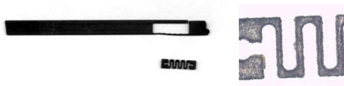
FIG. 2.6 – Ressort usiné à côté du brut (à gauche) grossi 5 fois (à droite)
